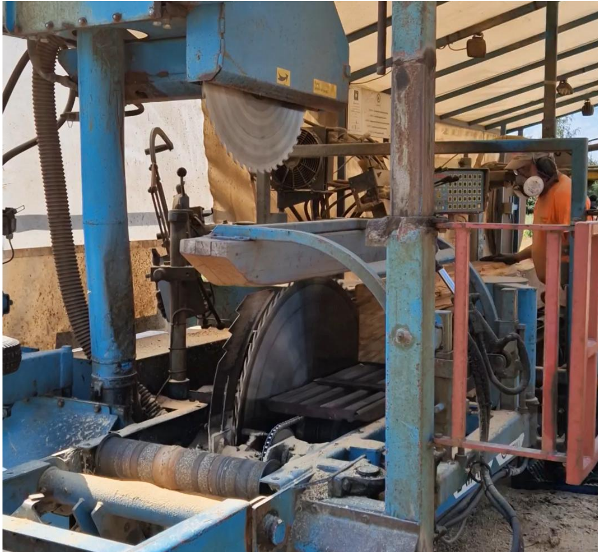
Liimapuiden sahaus uusiin mittoihin kenttäsirkeillä
