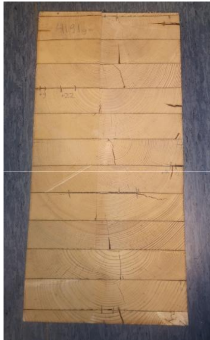
Liimapuun poikkileikkaus delaminointitestin jälkeen
