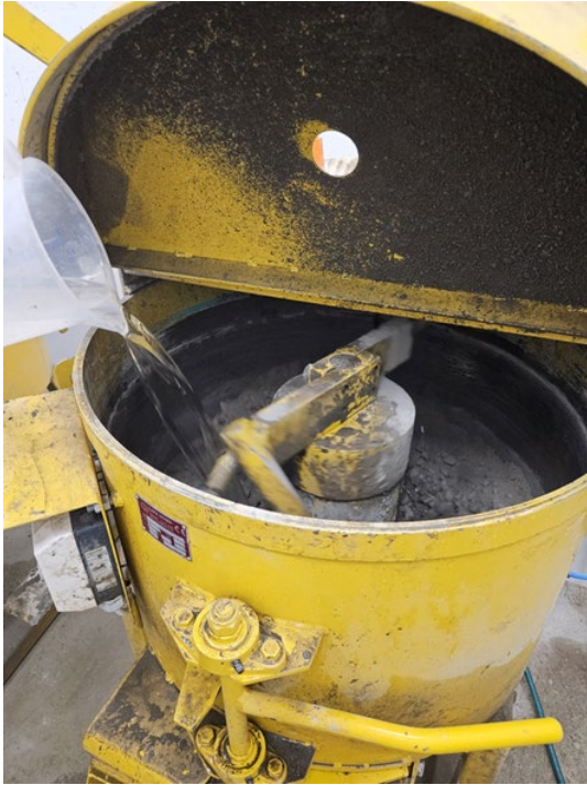
Kuva 1: sekoitus tasosekoittimessa (kuva: Salla Pulliainen)
