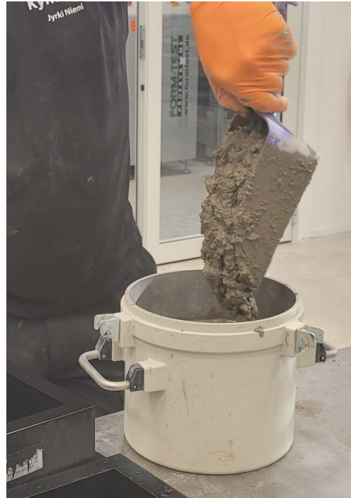
Kuva 3: ilmamäärän mittaus manuaalisella paineilmalaitteella (kuva: Leena Pekurinen)
