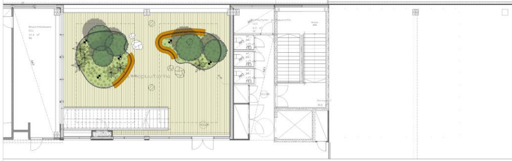
1:100 5. kerroksen kattopuutarha: korotetut istutussaltaat ja puuterassi
